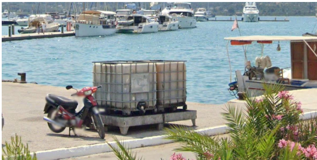
Εικόνα 10: Πλαστικές Παλετοδεξαμενές Χωρητικότητας 1.000lt για Συλλογή Πετρελαϊκών Καταλοίπων & Απόβλητων Λιπαντικών Ελαίων (λιμένας Πόρτο Χελίου)
